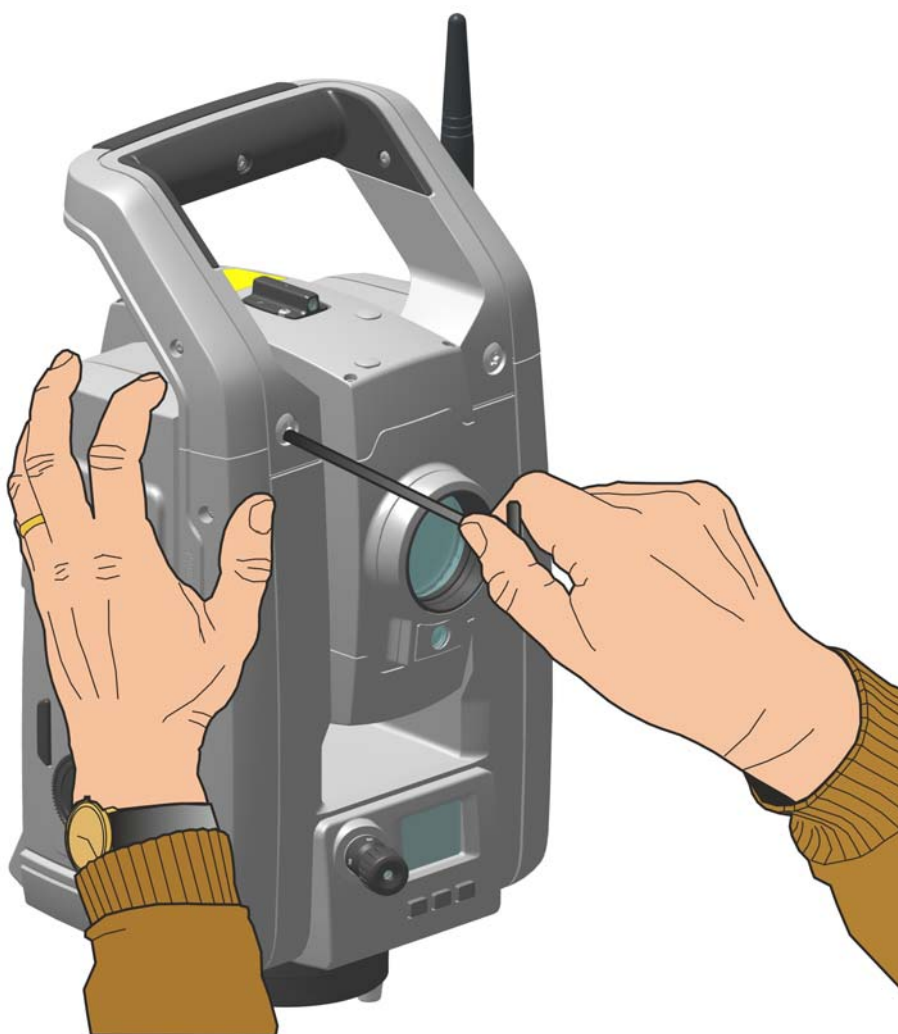
Рисунок 3.13. Отсоединение ручки инструмента
