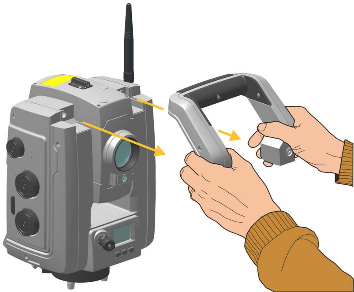
Рисунок 3.14. Отсоединение ручки инструмента
