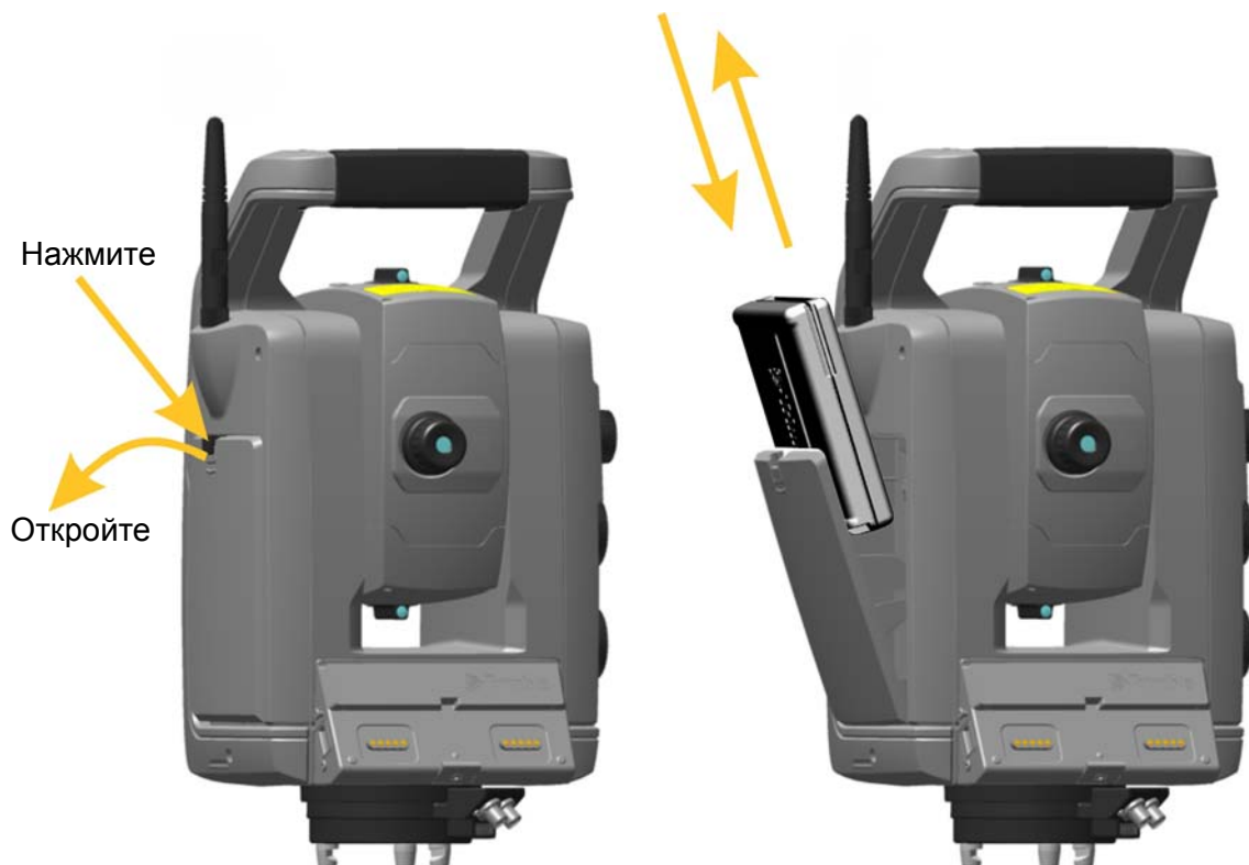
Рисунок 3.7. Установка и извлечение внутренней батареи
