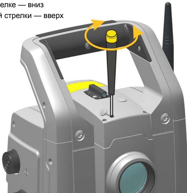
Рисунок 4.6. Юстировка положения лазерного указателя по вертикали
