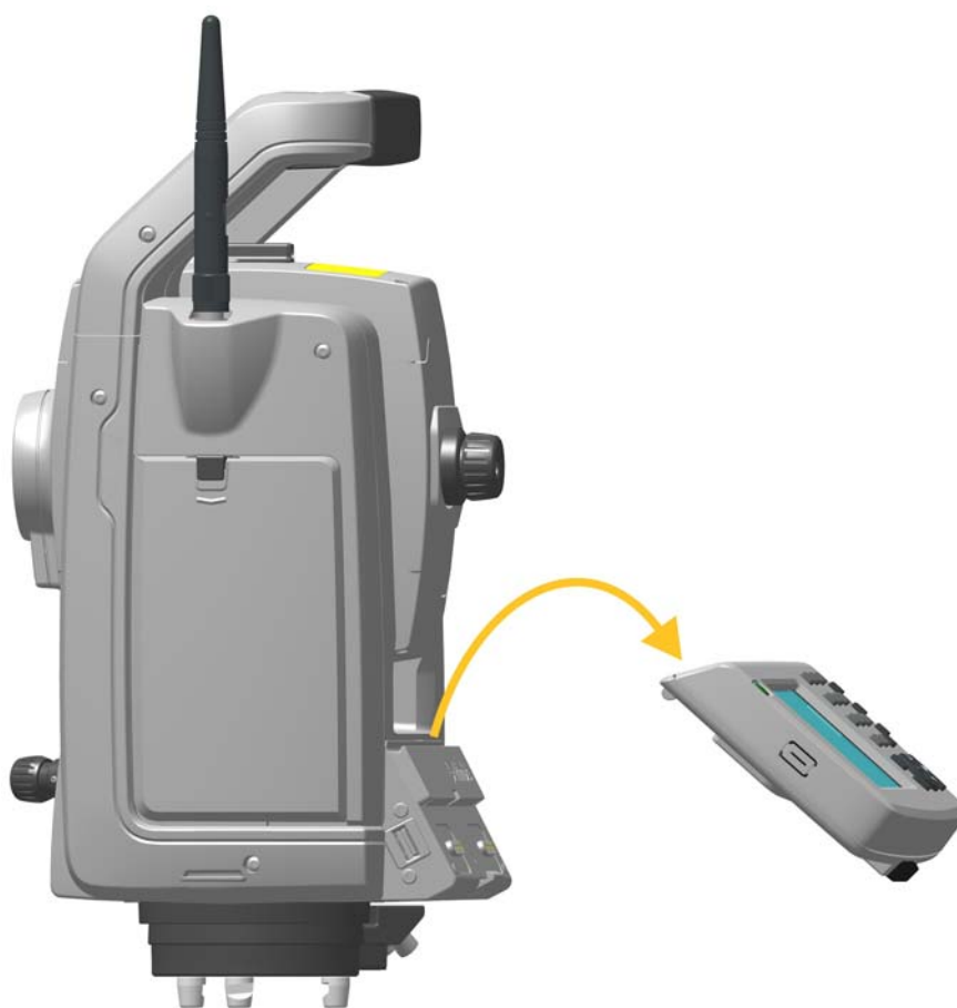
Рисунок 4.15. Снятие TCU с инструмента
