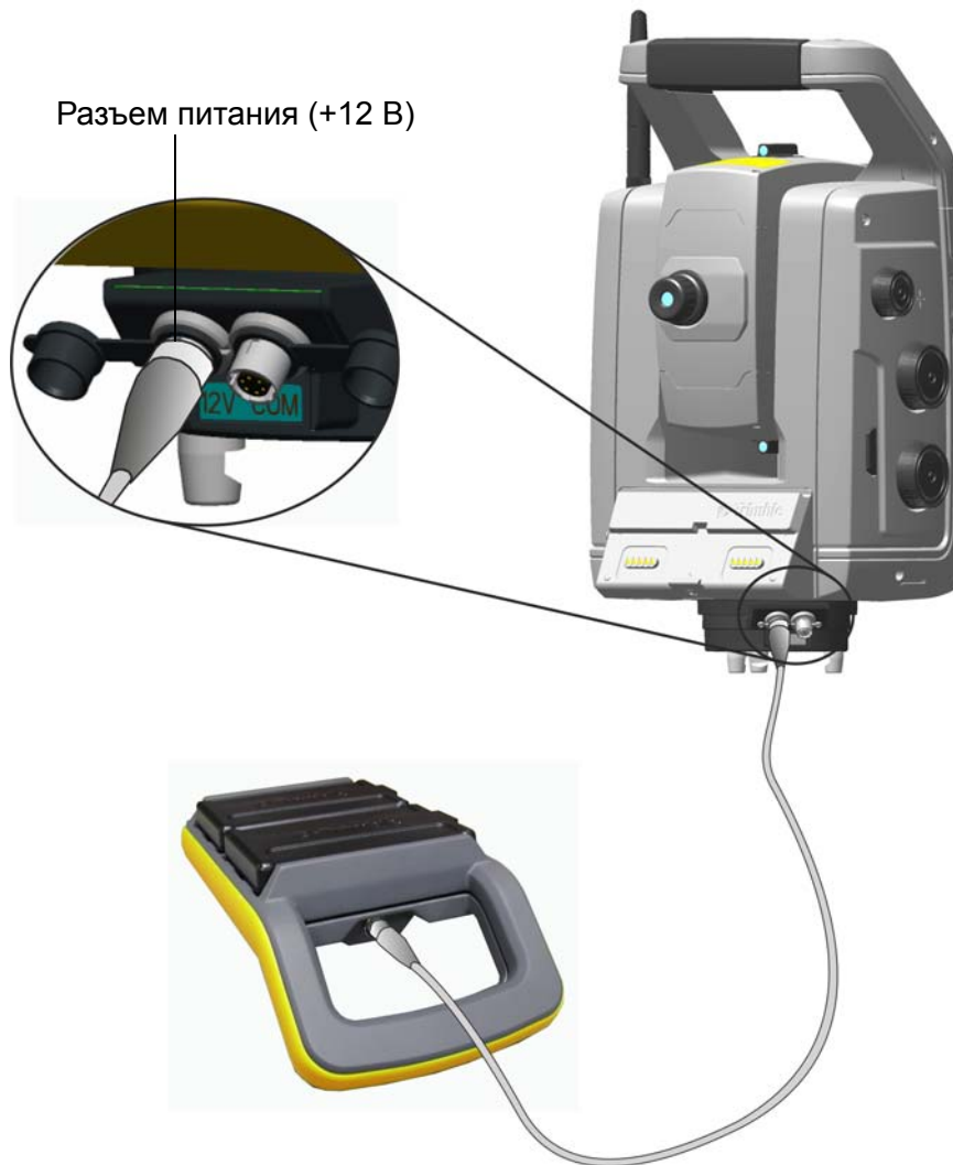
Рисунок 6.2. Подключение адаптера для нескольких батарей
